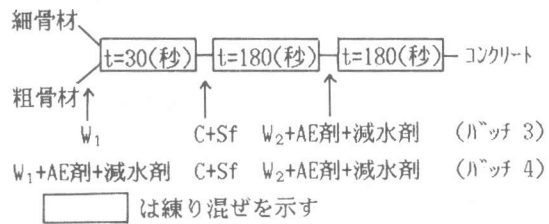
図-1 SEC工法の練り混ぜ順序
