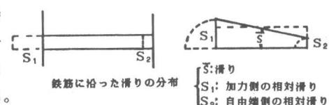
図-5 付着応力度と滑りの分布の模式図
