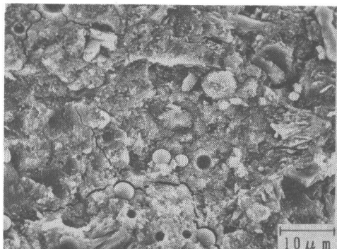
写真-3 液体窒素で冷却したときの硬化体破面 (材令13週)
