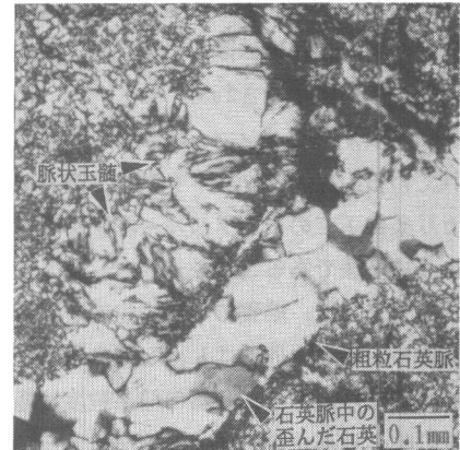
写真2 偏光顕微鏡写真。チャート中の玉髓と粗粒石英脈
