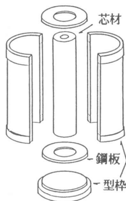
図一2 中空供試体の作製方法
