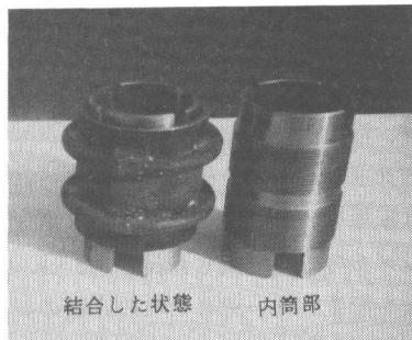
写真-1、試作ボックスジベル
