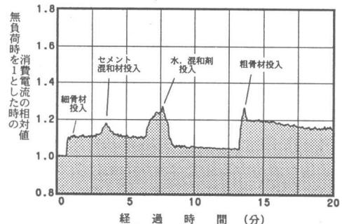
図 2. ミキサ消費電流経時変化 (W/C+S=24%, s/a=40%)
