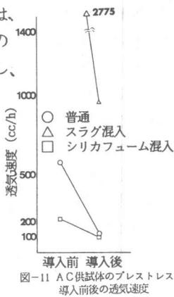
図-11 AC供試体のプレストレス導入前後の透気速度
