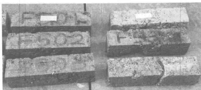
空隙率 0% 空隙率 3%
