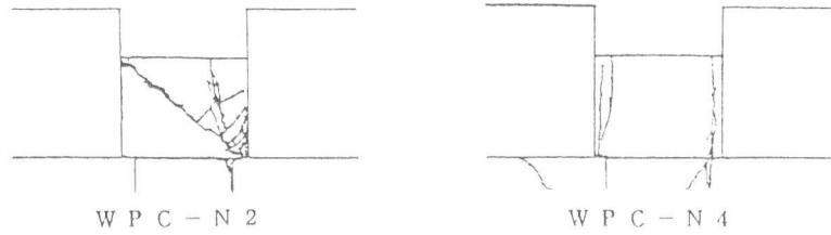
図4 頭つなぎ部破壊状況図
