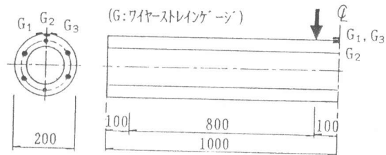
図3 曲げ圧縮ひずみの測定方法
