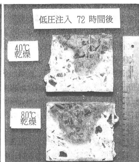
写真-2 低圧注入によるLiNO<sub>2</sub> の含浸状態
