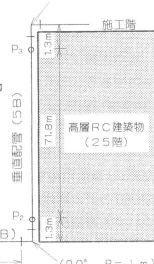
図-1 配管および管内圧力測定位置
