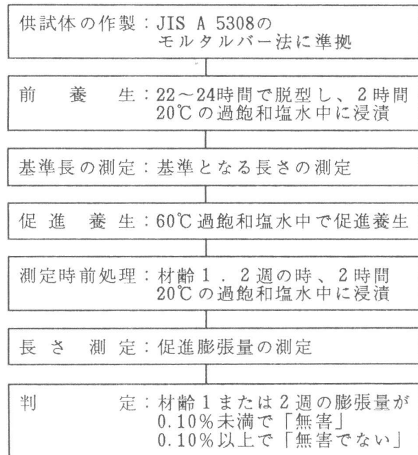
図-4 過飽和塩水浸漬法のフロー図
