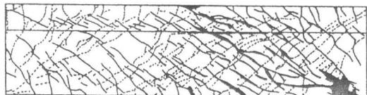
(b)B4, 水平打ち継ぎ面滑り破壊
