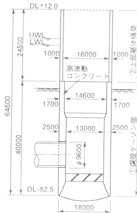
図-1 到達立坑断面図（完成時）
