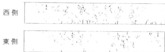
図-3 電流を印加したRC配合試験体のひびわれ状況
