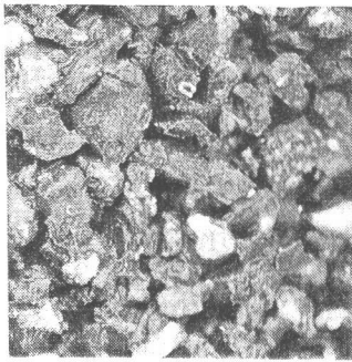
写真1 ポーラスコンクリート, 写真2 植栽への適応, 写真3 生物付着の状態
