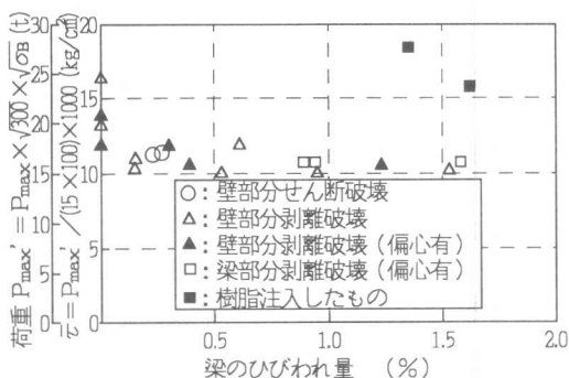
図-10 ひびわれ量と最大荷重
