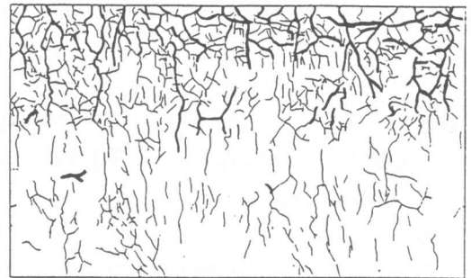
図-2 ひび割れ発生状況
