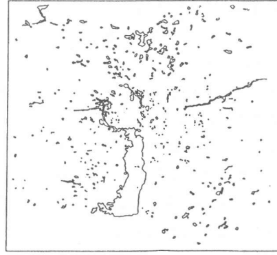
図-5 (d) 普通コンクリート(配合B) 表面仕上がり状況
