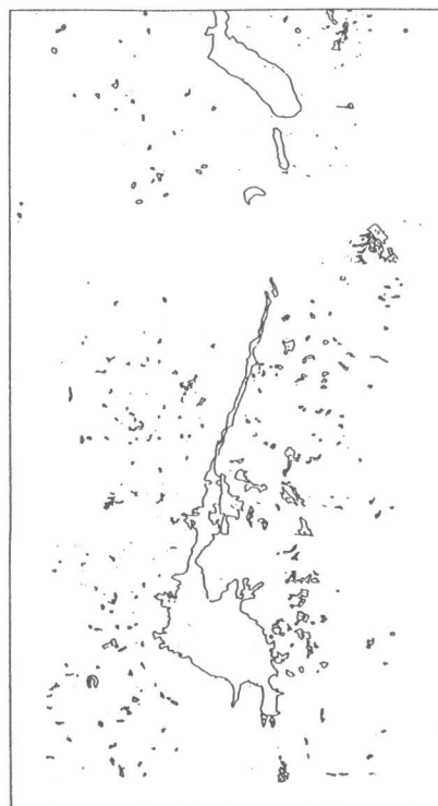
図-5(b) 普通コンクリート(配合A①) 表面仕上がり状況
