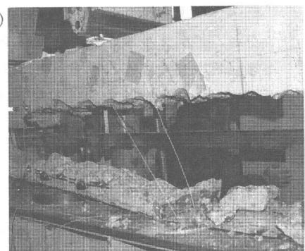
写真-2 最終破壊状況(高弾性)
