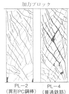
図-8 載荷①破壊状況
