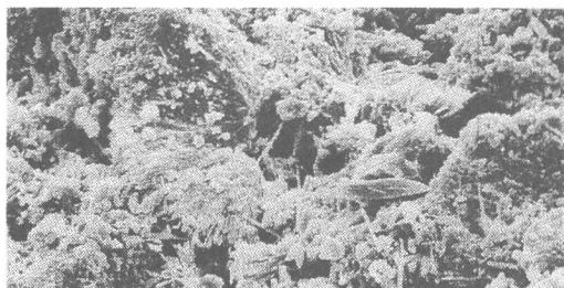
写真-2 電子顕微鏡写真 ( $\text{CaCl}_2$ 溶液浸漬) 倍率500倍  $\longleftrightarrow 20 \mu\text{m}$
