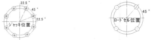
図-4 曲線推進実験 (急曲線用推進管)
