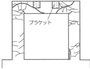
図-8 A-1 供試体 ひび割れ図
