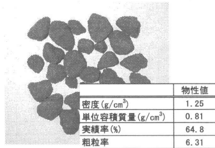
写真-1 軽量粗骨材の外観と物性
