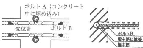
図-2 抜け出し変形の測定方法
