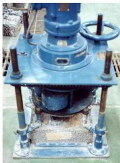
写真－１ 摩耗試験機の外観 (摩耗試験 1)
