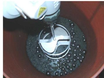
写真－２ 摩耗試験機の内部 (摩耗試験 2)
