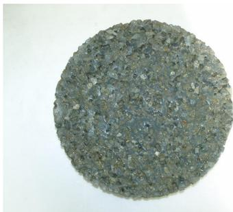
写真-4 試験後の供試体（摩耗試験2）
