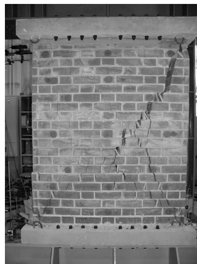
図 - 22 せん断卓越型崩壊 (B2)
