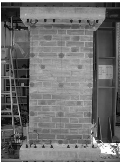
図 - 21 曲げ卓越型崩壊 (B1)
