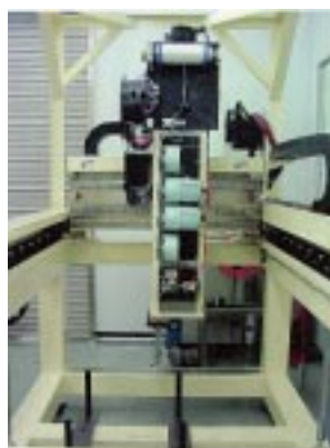
写真-2 自動配筋ロボット
