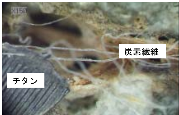
写真－3 通電処理後の炭素繊維グリッド
