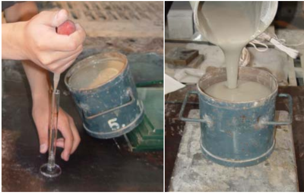
図-3 ブリーディング試験状況
