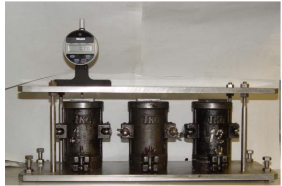
図-4 収縮試験状況
