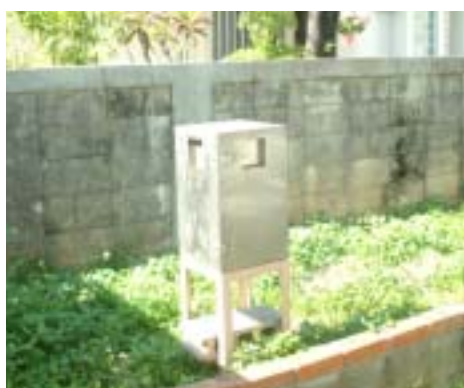
写真-2 住宅庭に設置した飛来塩分捕集器
