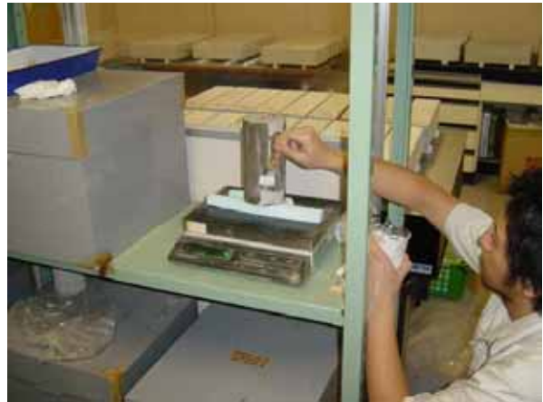
写真-1 浸透性吸水防止剤の塗布(φ10×20cm)
