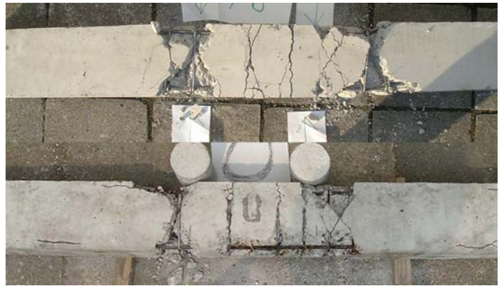
図-5 荷重後の供試体の例(上:健全供試体,下:腐食減量率1.5%,ひび割れ幅0.9mm)
