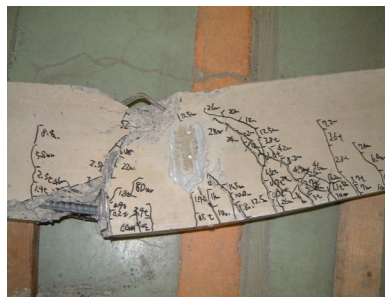
写真 - 2 スターラップ切断供試体 Bre.3-b の破壊状況
