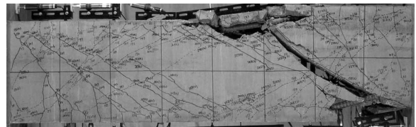
試験体 No. 7 (破壊形式: S)
