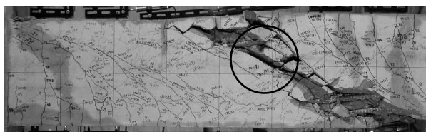
試験体 No. 1 (破壊形式: S)
