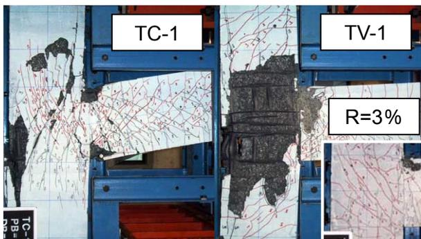
写真 - 1 最終破壊状況
