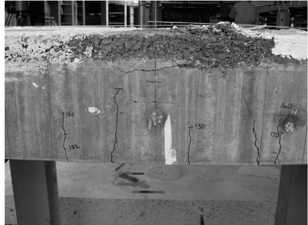
写真-1 静載荷試験破壊状況
