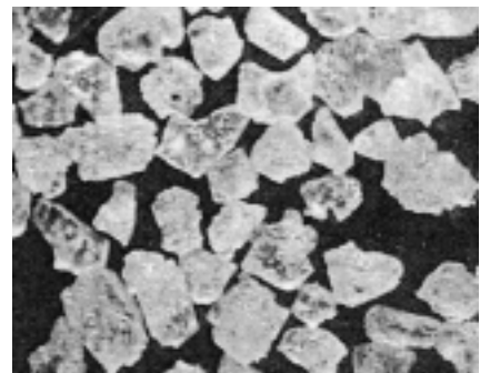
写真-2 粒形改善した硬質水砕スラグの形状
