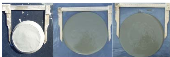
写真-2 スラグ添加型・高粘性型・低粘性型グラウトのフロー状況
