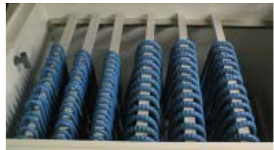
写真-6 塩水噴霧試験の状況
