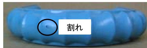
写真-2 曲げ加工時の塗膜の破損状況 (D25, 300 \mu\text{m} )
