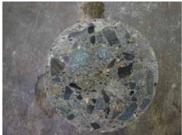
写真 - 1 EPMA 用試験体の切断状況
