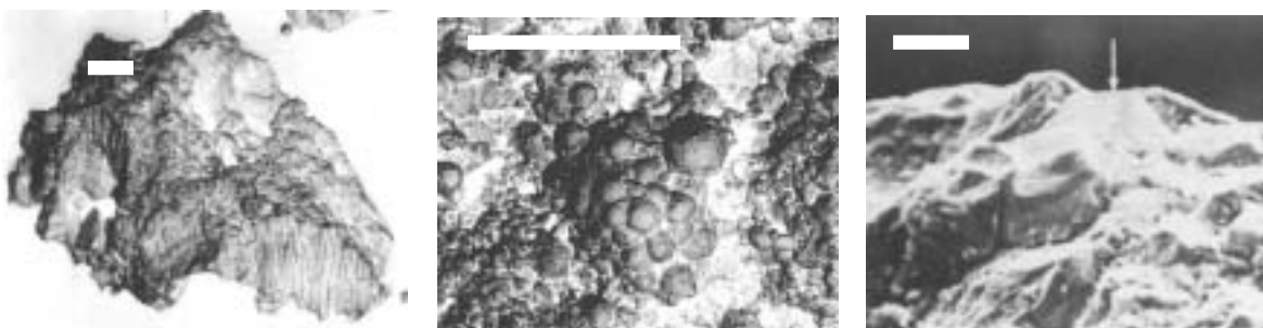
(1) 洪積固結粘土中の黄鉄鉱全体像 (2) 同左の近接像 (フランボイダル型) (3) 第三紀頁岩層中の黄鉄鉱 (自形型)
