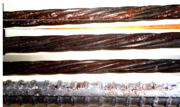
写真-1 鋼材の腐食状況 ( \text{Cl}^- = 9\text{kg/m}^3 ) (上からP9H, P9M, P9N, R9N)
