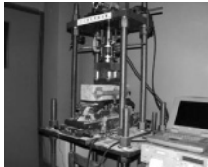
図-5 破壊靱性供試体と試験状況
