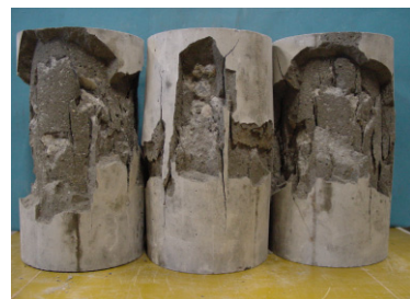
写真-1 ガラパクトコンクリートの 圧縮強度試験時の破壊状況
