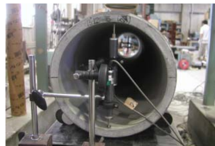
写真-2 変位計設置状況
