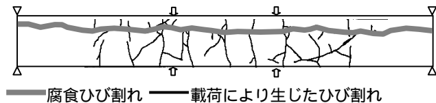
図 - 6 ひび割れ状況 (N-5)
